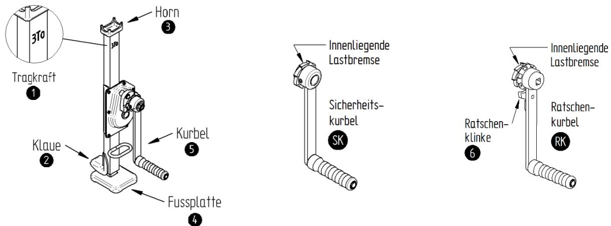
Die auf dem Schaft eingeprägte Tragkraft (1) darf nicht überschritten werden. Diesem Punkt ist insbesondere bei dynamischer Belastung (Schlag, Erschütterungen) Beachtung zu schenken. Die Zahnstangenwinde ist nicht darauf ausgelegt, Vibrationsbelastung aufzunehmen.
